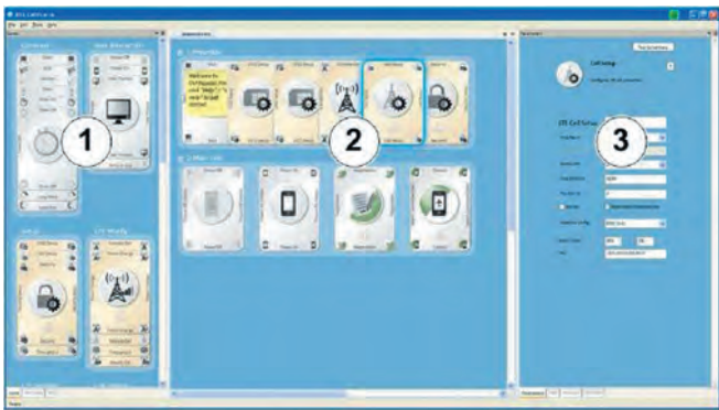
Рис. Внешний вид графического интерфейса CMWCard: 1 – окно доступных действий; 2 – формируемый сценарий; 3 – окно детальной настройки
