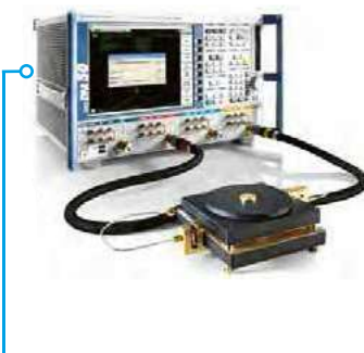
Измерение параметров пленок на основе резонатора
