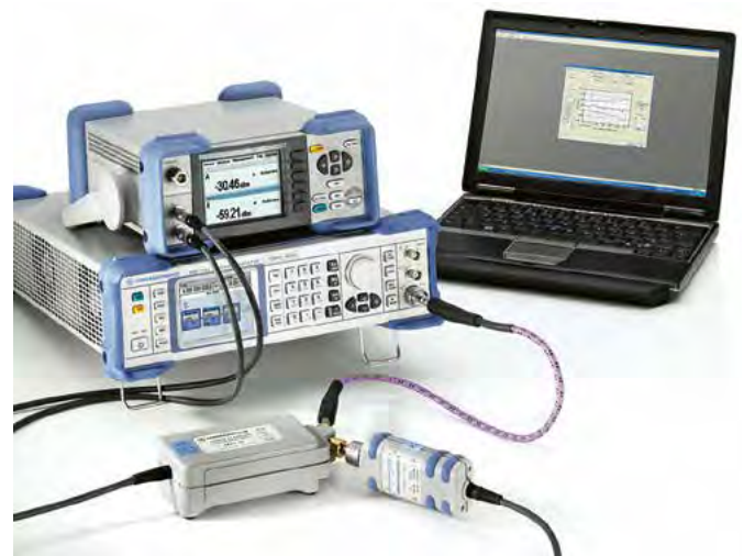
Измерительная установка для калибровки преобразователя мощности NRP-Z55
