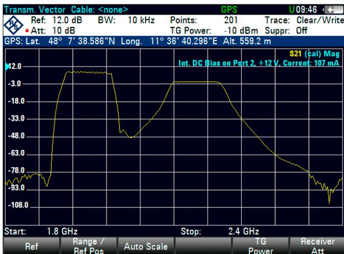
Измерение характеристик передачи ТМА: встроенный источник напряжения, текущее измерение с подключенным GPS-приемником R&S®HA-Z240
