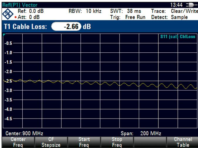
Однопортовое измерение потерь в кабеле
