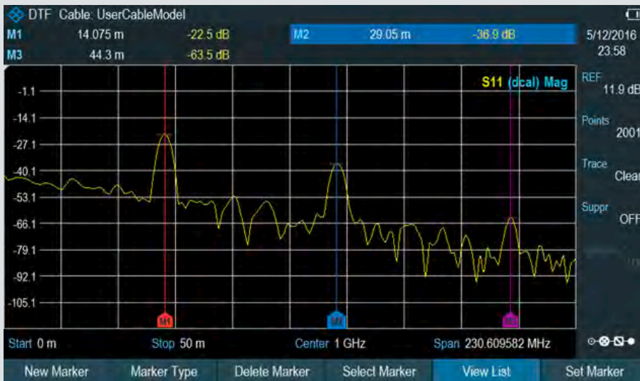
Измерение расстояния до места повреждения
