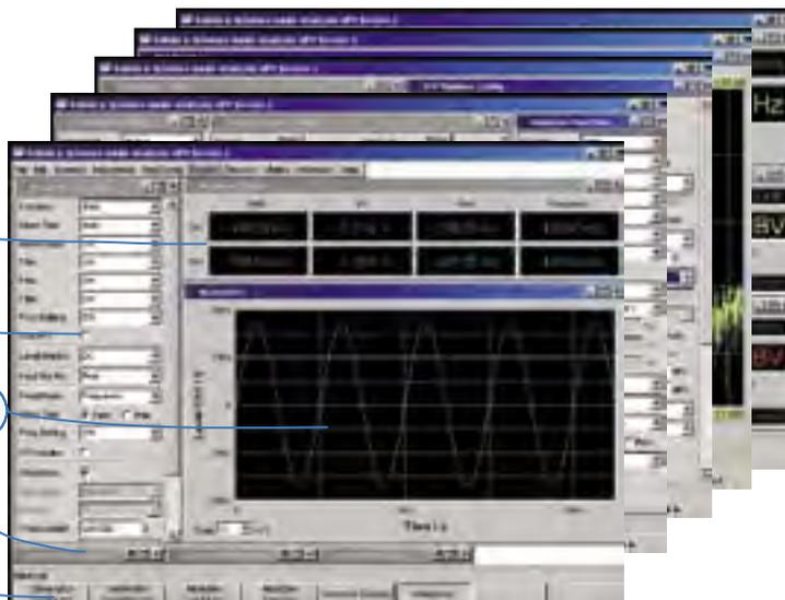
*Большой экран обеспечивает одновременное отображение всех основных настроек анализатора и результатов измерений. Все многочисленные панели и окна распределены по пяти основным рабочим экранам*
