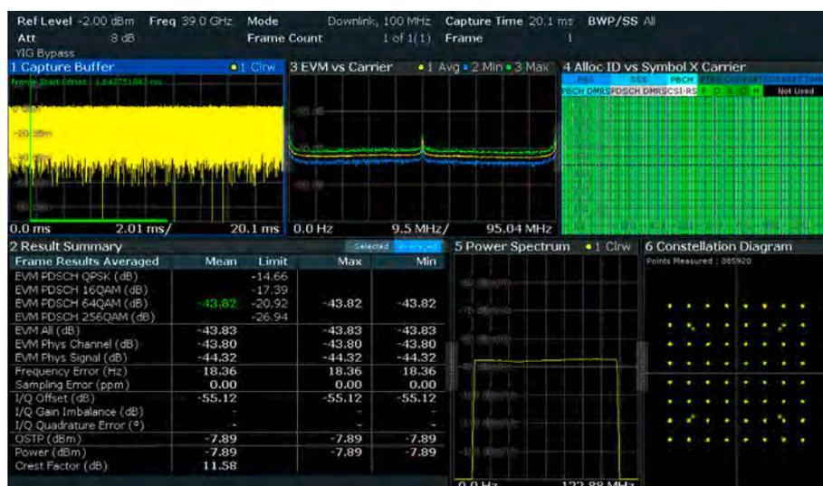
Измеренное значение EVM сигнала 5G NR (полоса канала 100 МГц, схема модуляции 64QAM PDSCH, несущая частота 39 ГГц).
