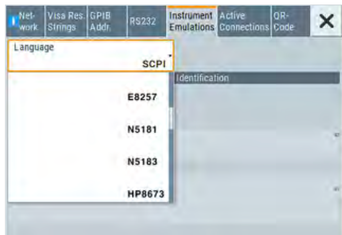
Эмуляция приборов с помощью генератора R&S®SMA100B
