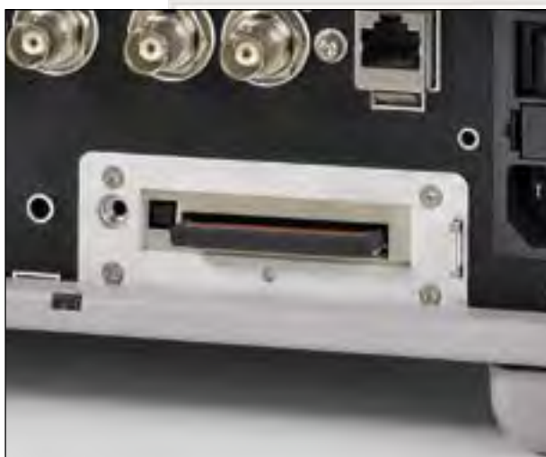
Флэш-диск (CompactFlash™) в задней части прибора
