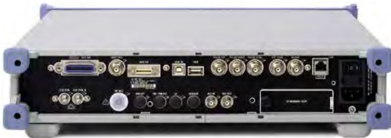
Задняя панель генератора R&S SMA100A с разъемами интерфейсов
