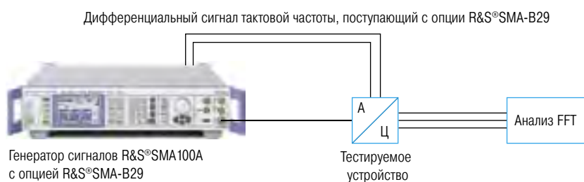
Пример применения: тестирование А/Ц преобразователя с помощью R&S®SMA100A
