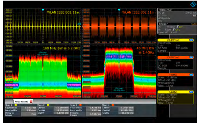
Многоканальный частотный анализ сигналов WLAN IEEE 802.11n и 11ac MIMO в осциллографе R&S®RTP
