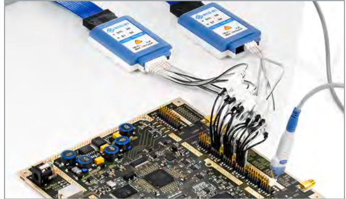
Каждый осциллограф R&S®RTP может быть оснащен дополнительными 16 цифровыми каналами прямо на месте эксплуатации
