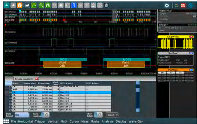
Цифровые каналы идеально подходят для запуска и декодирования низкоскоростных последовательных интерфейсов, таких как SPI
