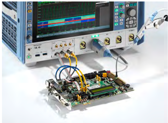
Измерение LVDS сигналов с помощью встроенного генератора сигналов произвольной формы, формирующего тактовый сигнал и 8-битный шаблон данных для программирования и управления устройством
