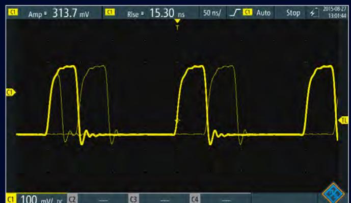
Высокоскоростная система сбора данных осциллографа R&S®Scope Rider захватывает до 50 000 осциллограмм/с, позволяя выявлять редкие аномалии сигнала.
