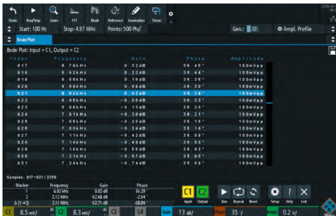
В таблице результатов измерений содержатся подробные данные о каждой измеренной точке, которые включают в себя частоту, коэффициент усиления и фазовый сдвиг
