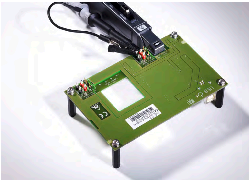
Плата коррекции и калибровки силовых измерений R&S®RT-ZF20: удобная коррекция для измерений в силовой электронике.
