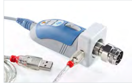
Адаптер R&S®RT-ZA9 N-типа (вилка) для активных широкополосных пробников для использования с анализаторами спектра и сигналами
