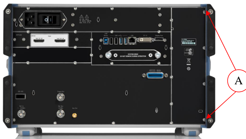
Рисунок 2 - Схема пломбировки от несанкционированного доступа (А)
