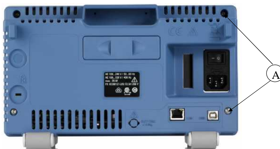
Рисунок 2 - Схема пломбировки от несанкционированного доступа (А)
