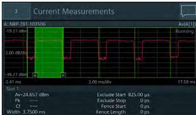
Измерение таймслотов сигнала Bluetooth® с исключением начального времени
