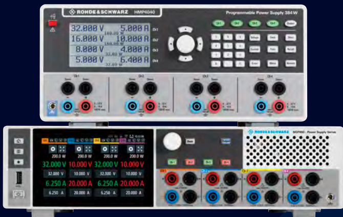
Четырехканальные источники питания R&S®HMP4040 и R&S®NGP814
