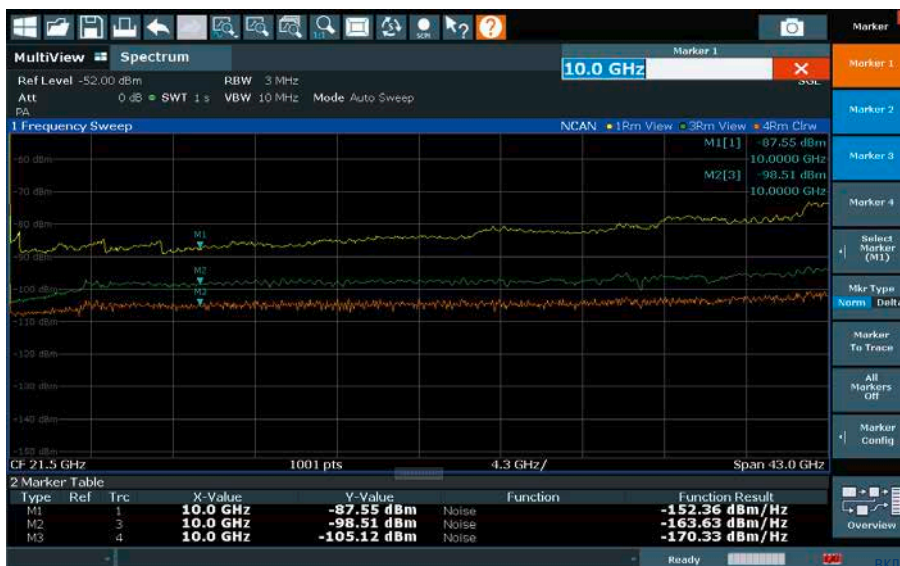
Средний уровень собственного шума (DANL) анализатора R&S®FSW43 с предусилителем и включенным/выключенным шумоподавлением
