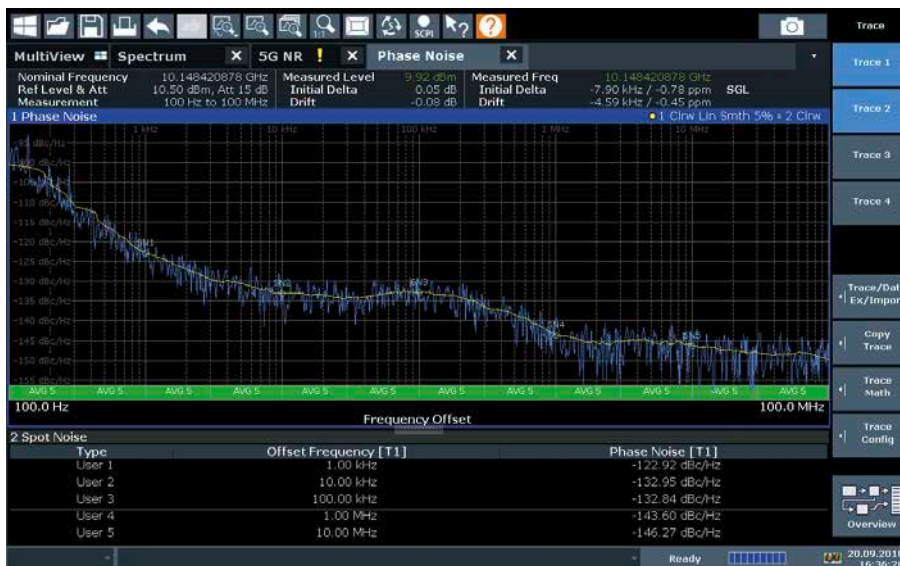
Фазовый шум при отстройке 10 кГц от несущей 10 ГГц; тип. –133 дБн/Гц
