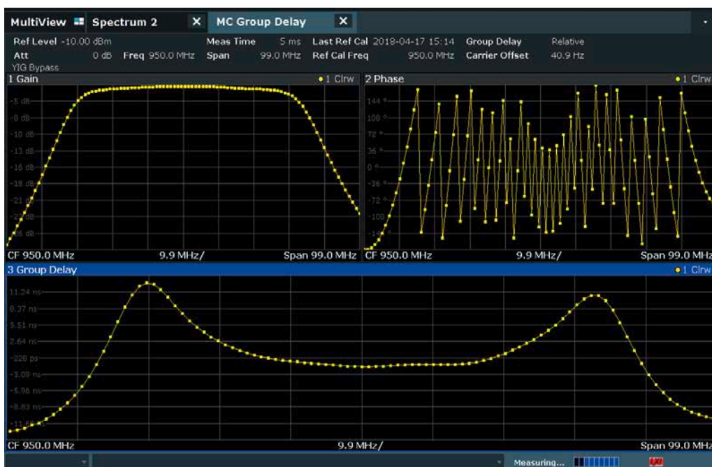
Измерение относительного ГВЗ полосового фильтра
