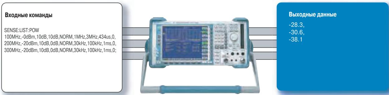
**Дистанционное управление R&S®FSP по интерфейсу IEC/IEEE в режиме списка сокращает время измерений**
