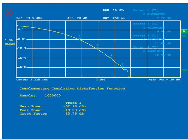
**Измерение комплементарной функции распределения WCDMA сигнала**
