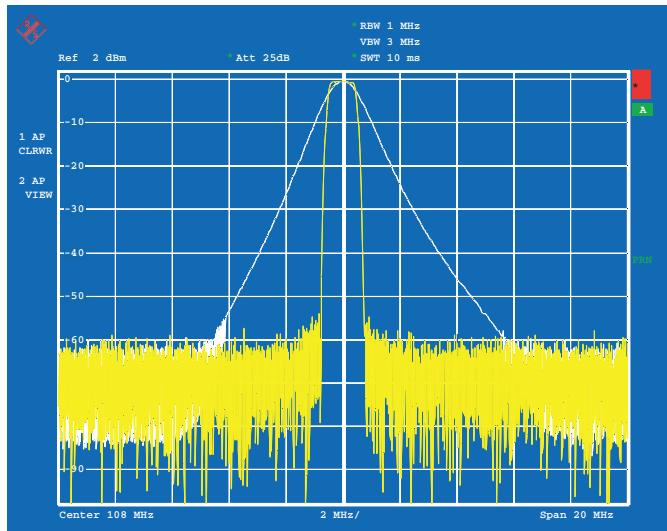
Сравнение канального фильтра на 1 МГц и обычного фильтра с полосой 1 МГц
