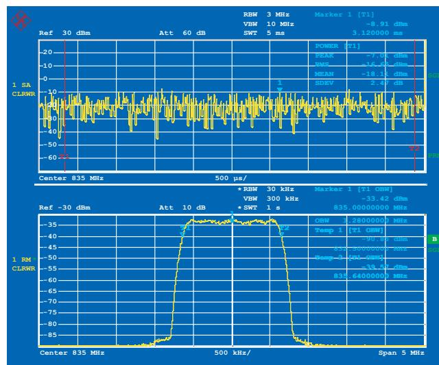
**Измерение мощности пакета (верхний график)**
