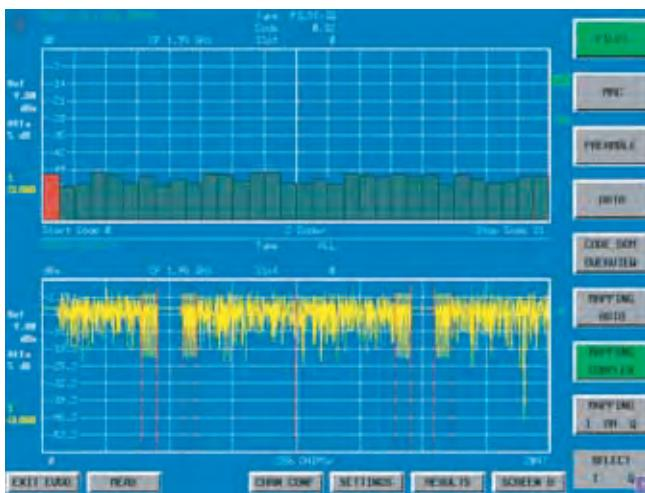
Мощность ошибки и мощность слота для 1xEV-DO сигнала, измеренное при помощи R&S®FS-K84
