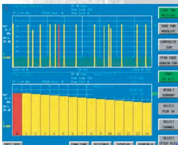
Измерение мощности в кодовой области в зависимости от временного слота
