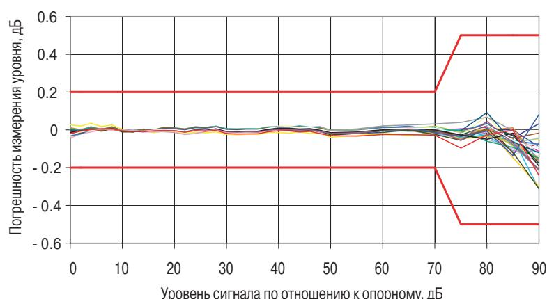
**Линейность отображения при разрешающей способности ≤ 100 кГц (измерено на 30 приборах)**
