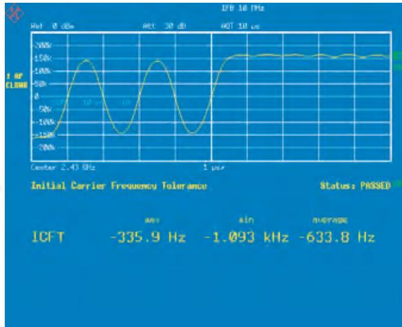
Измерение начального отклонения частоты несущей сигнала Bluetooth с помощью R&S®FS-K8
