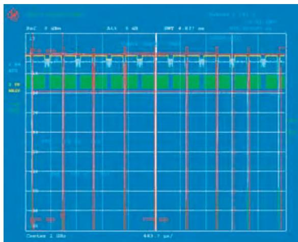
Одновременное измерение мощности в зависимости от времени для восьми временных слотов сигнала EDGE
