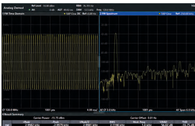
Отображение модулирующего сигнала и его спектра вместе с пиковым значением и среднеквадратическим отклонением
