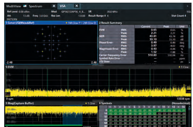
Демодуляция сигнала DVB-SX2 с несколькими модуляциями с помощью опции R&S®FPL1-K70M (требуется опция R&S®FPL1-K70)
