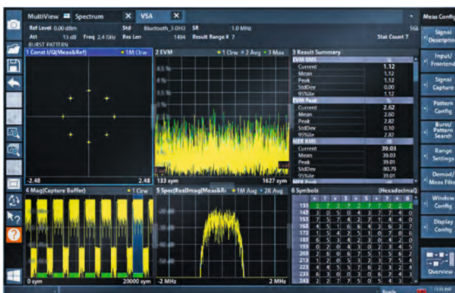
Демодуляция сигнала Bluetooth с помощью опции R&S®FPL1-K70
