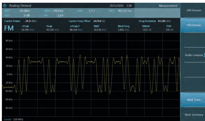
Опция R&S®FPC-K7: анализ ЧМ-модуляции
