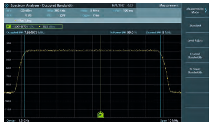
Опция R&S®FPC-K55: измерение занимаемой полосы частот
