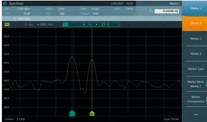
Опция R&S®FPC-B22: высокая чувствительность с внутренним предусилителем
