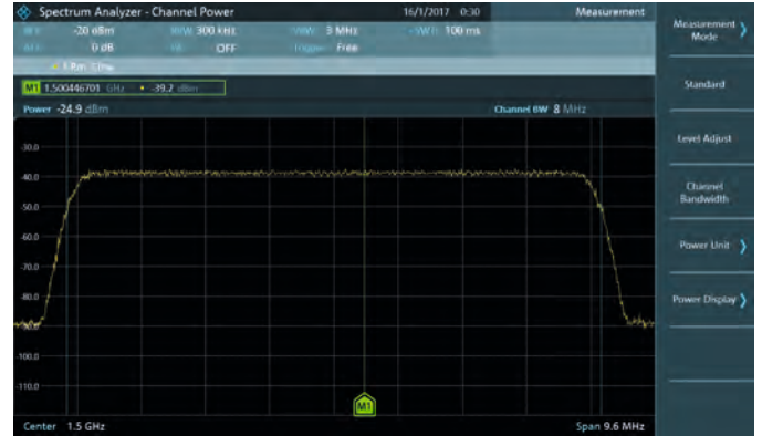
Опция R&S®FPC-K55: измерение мощности в канале
