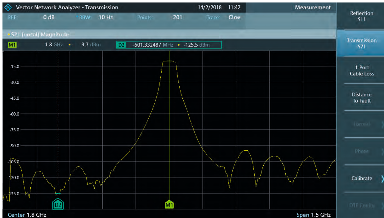
Анализатор R&S®FPC1500: скалярное измерение коэффициента передачи S_{21} с помощью опции R&S®FPC-K42
