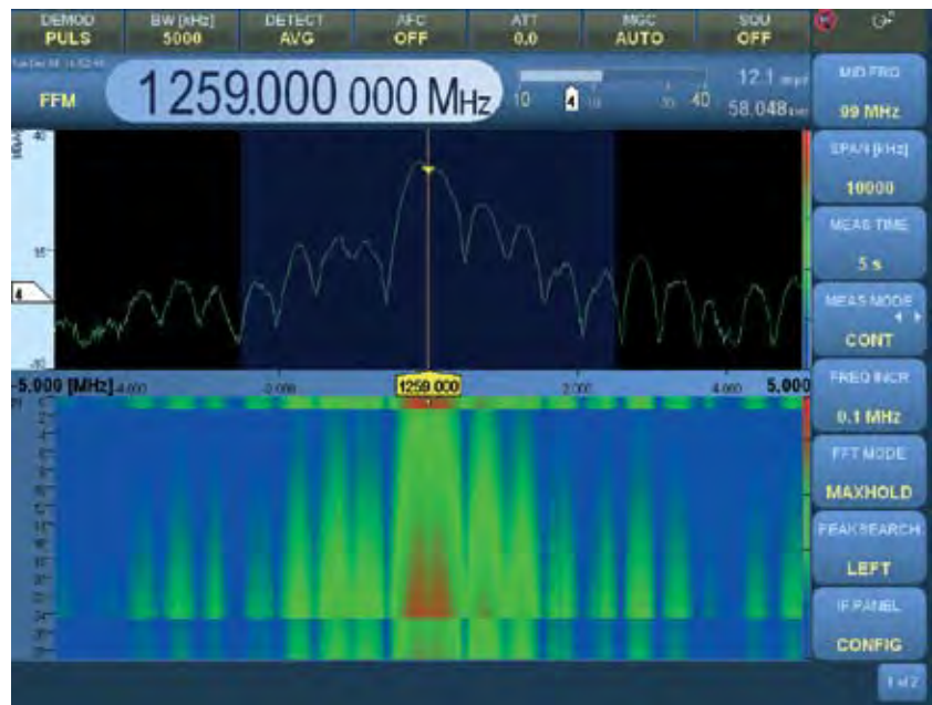
Обнаружение и анализ импульсного сигнала радара.
