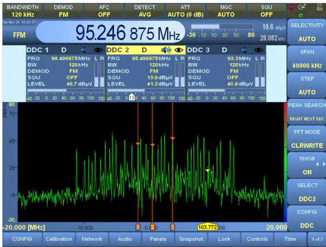
Рис. 1-3. Опция цифровых приемников R&S®EB500-DDC
