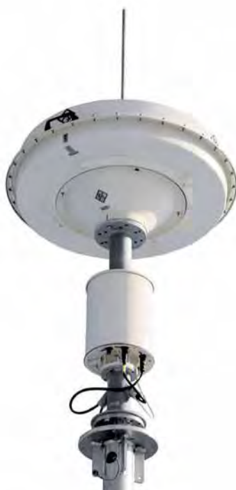
Рис. 5-2. Расположение пеленгаторных антенн на антенной мачте стационарного комплекса радиомониторинга и пеленгования. Антенна R&S®ADD197 снизу, R&S®ADD071 сверху
