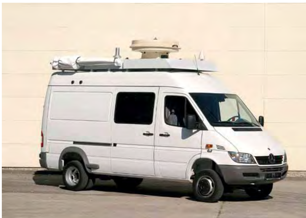
Рис. 5-1. Мобильный комплекс радиомониторинга и пеленгования. Антенна R&S®ADD295
