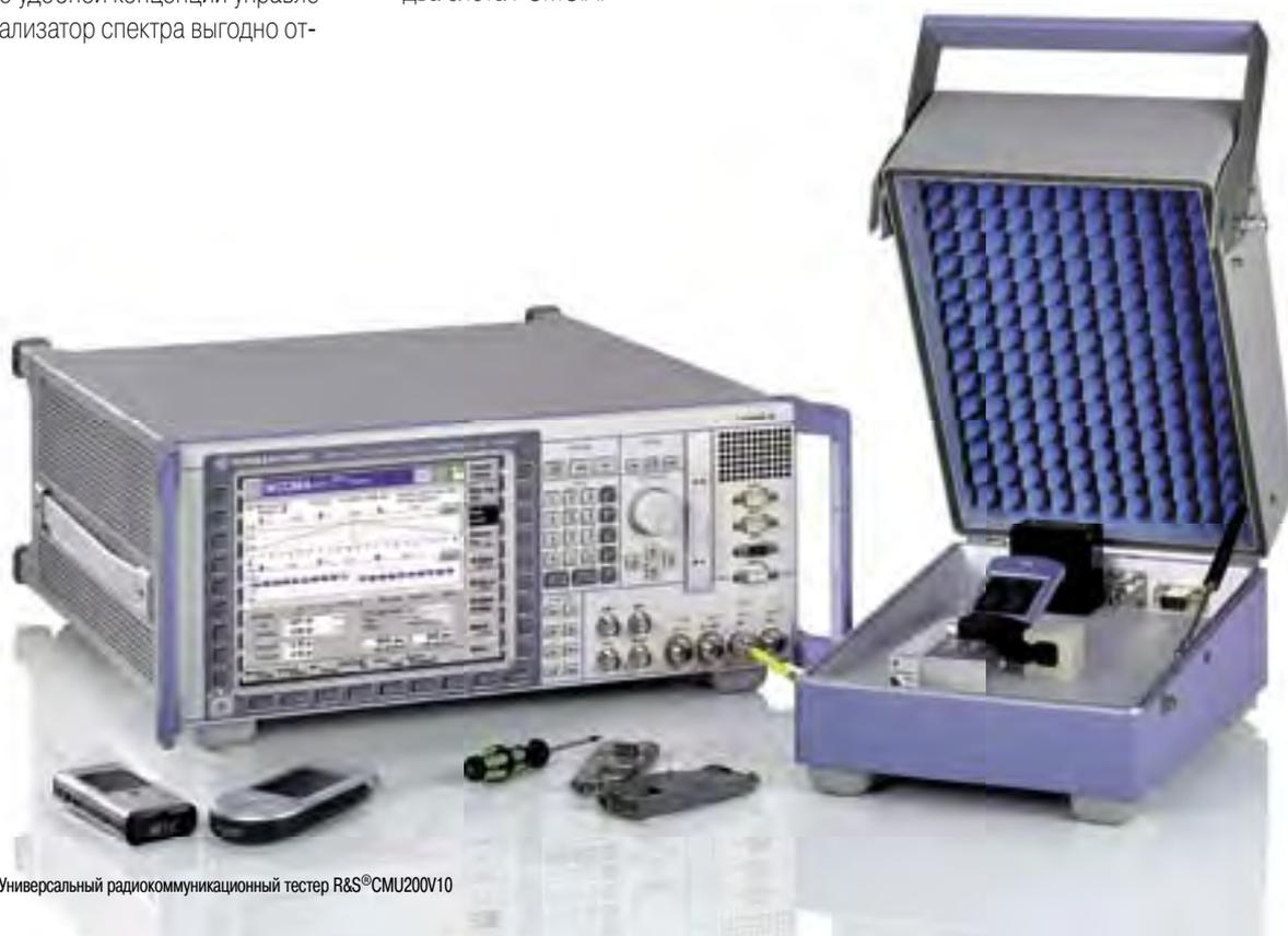
Базовый блок выполняет функции ВЧ анализатора/генератора общего назначения.
