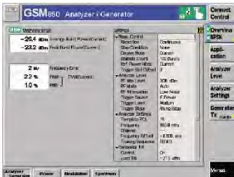
Меню обзора дает быструю и исчерпывающую информацию о ВЧ параметрах мобильного телефона; расположенные у нижнего края экрана горячие клавиши предоставляют мгновенный доступ к специальным и подробным измерениям GSM.
