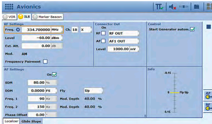
ILS glide slope generator.
